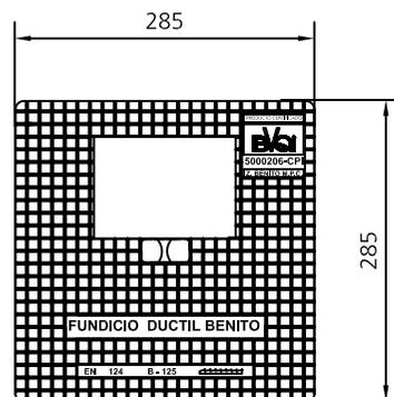
Realizadas en fundición dúctil. Cumplen con las prescripciones de la norma EN-124.
