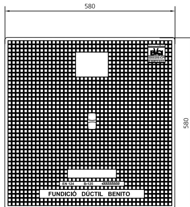
Realizadas en fundición dúctil. Cumplen con las prescripciones de la norma EN-124.
