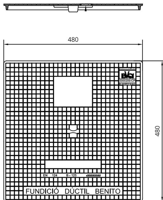
Realizadas en fundición dúctil. Cumplen con las prescripciones de la norma EN-124.
