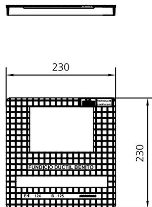
Realizadas en fundición dúctil. Cumplen con las prescripciones de la norma EN-124.
