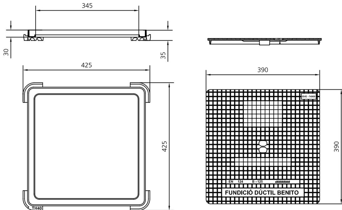
Realizadas en fundición dúctil. Cumplen con las prescripciones de la norma EN-124.
