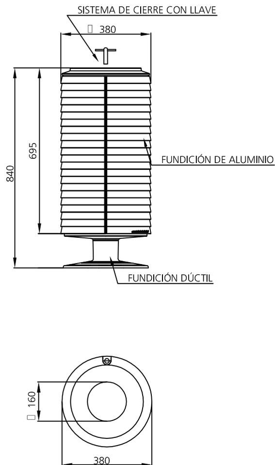
MATERIAL: Base de fundición dúctil, cuerpo de fundición de aluminio y cubeta interior en acero galvanizado. Cierre de acero inoxidable.
