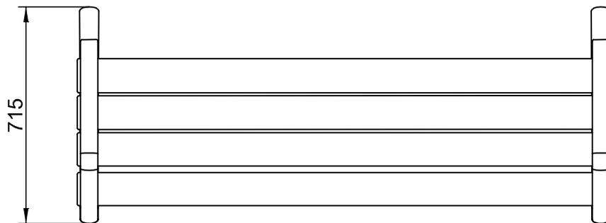
**MATERIAL:** Pies de fundición dúctil. Cuatro tablones de madera tropical. Tornillos de acero inoxidable.
