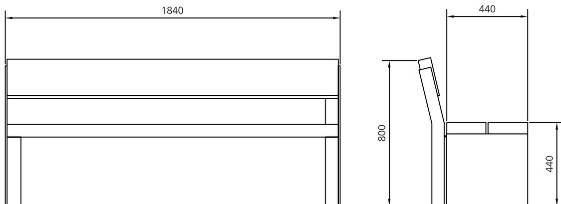
Material: Pies en plancha de acero de 8 mm .
