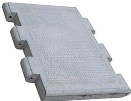
El **módulo Link-Wall**® (marca registrada y modelo patentado) está formado por una placa de hormigón armado con árido del 20 (HA-20) de configuración sensiblemente prismática, en la que dos de sus aristas presentan tres dientes de 25 cm. ancho las cuales permiten la unión entre módulos mediante un pasador que hace de bisagra con la que se consigue que la carga se reparta uniformemente a lo largo de toda la placa obteniendo así 5 puntos de unión.
