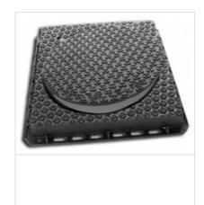
Tapa articulada, abatible hasta 120° y extraíble a 90° TP3A Cierre elástico, flexible en fundición con pestaña de retroceso. Marco cuadrado aparente, con junta de polietileno, antiruido. Inscripciones genéricas: S/N, CLAVEGUERAM, SANEAMIENTO, ABASTECIMIENTO.
