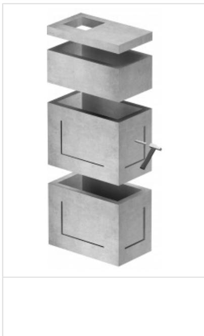
Reducciones rectangulares de arquetas y losas, que pueden tener la función de transición a otro elemento o bien como cierre del pozo.
