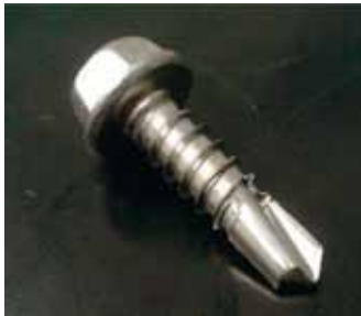
Tornillo din.7504-K 5,5x19 A2 (para fijación de grapa inoxidable a perfil).
