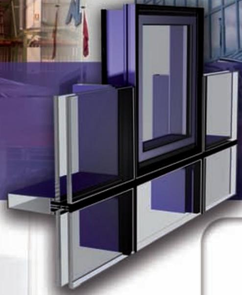
Sistema de fachada continua compuesta por una retícula de montantes y travesaños de diferentes secciones en profundidad en función de las dimensiones de los módulos y las cargas de viento. El acristalado se realiza mediante fijación directa a la retícula por medio de una pieza giratoria que se introduce entre los vidrios. Esta pieza se coloca en posición vertical para girarla posteriormente, quedando el vidrio sujeto.
