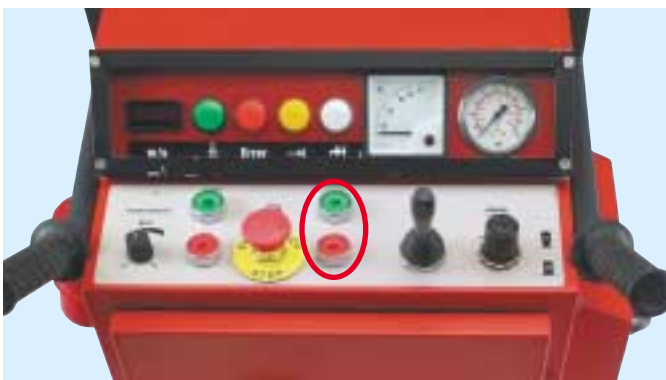
Atril de control, agua encendida / apagada
