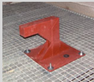
Fig. 2. Segundo Ensayo. Como resultado del anterior ensayo se realizó un diseño de placa de mayor dimensión (300x300mm) y de esta manera, reducir la deformación. A ésta se soldaron perfiles para poder realizar la prueba de tracción a una altura de 50 mm, separada del eje 200 mm y en la zona más desfavorable del Pabellón Puente (sección 9POD2) para obtener una transmisión de esfuerzos lo más cercana a la realidad.
