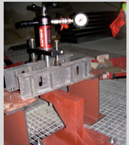
Fig. 2. Segundo Ensayo. Como resultado del anterior ensayo se realizó un diseño de placa de mayor dimensión (300x300mm) y de esta manera, reducir la deformación. A ésta se soldaron perfiles para poder realizar la prueba de tracción a una altura de 50 mm, separada del eje 200 mm y en la zona más desfavorable del Pabellón Puente (sección 9POD2) para obtener una transmisión de esfuerzos lo más cercana a la realidad.
