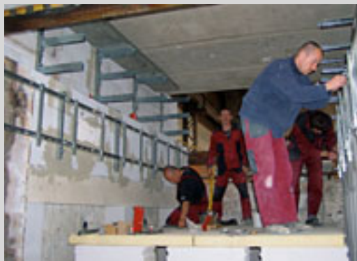
Figura 3. Ensayo de resistencia al fuego Hilti. Interior del horno de ensayo con el montaje previo de los sistemas de instalación, ensayo y estado de las piezas una vez terminado el ensayo.
