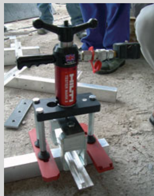
Ensayo a tracción sobre perfiles metálicos de aluminio con tornillo autoladrante Hilti S-MD03S6.3x25.
