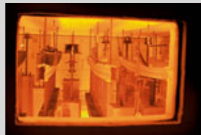
Figura 3. Ensayo de resistencia al fuego Hilti. Interior del horno de ensayo con el montaje previo de los sistemas de instalación, ensayo y estado de las piezas una vez terminado el ensayo.
