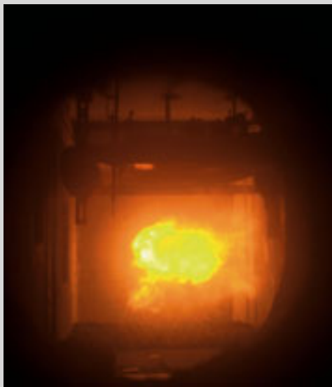
Figura 3. Ensayo de resistencia al fuego Hilti. Interior del horno de ensayo con el montaje previo de los sistemas de instalación, ensayo y estado de las piezas una vez terminado el ensayo.
