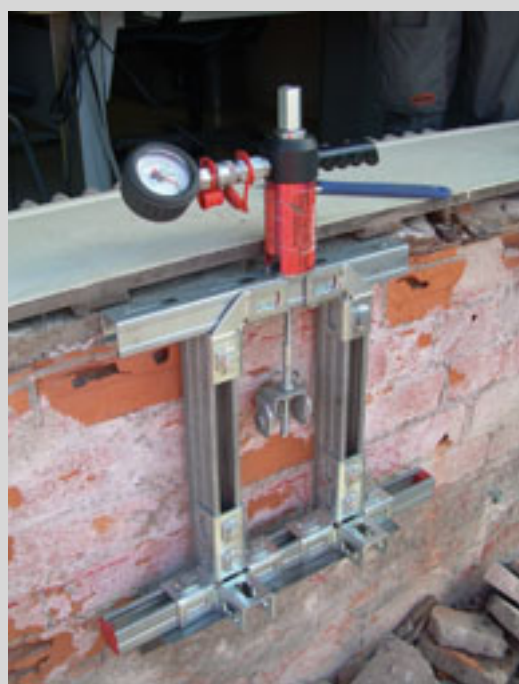
Ensayo a cortante de anclaje químico Hilti HIT HY-70 sobre ladrillo hueco doble.
