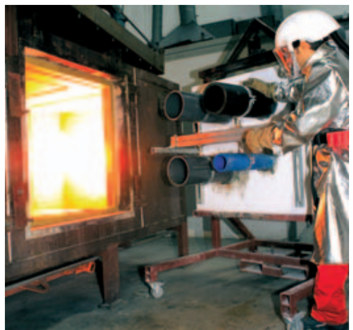
Ensayo de un Sistema de Protección Pasiva para un paso de tubería de PVC
