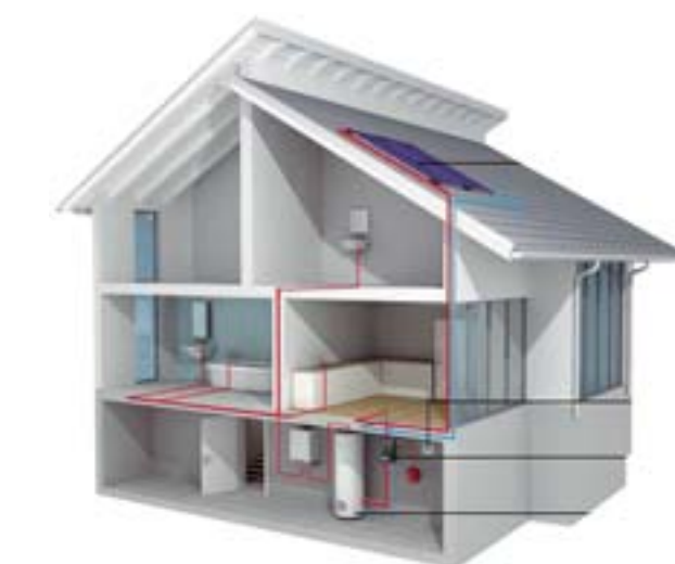
Instalación colectores solares
