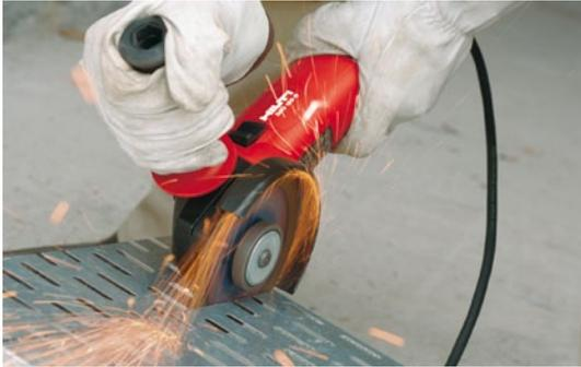
Discos Hilti AC-D. Para el corte de cualquier elemento metálico.
