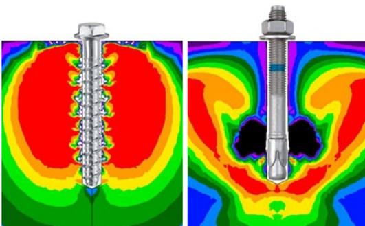
**E**l anclaje tipo HUS, representa una nueva dimensión en el diseño de los anclajes mecánicos. A continuación vamos a exponerle algunas de las características más destacadas que este anclaje tiene.
