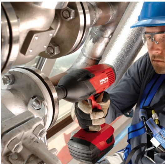
Montaje y desmontaje de tuercas de M12 a M24.
