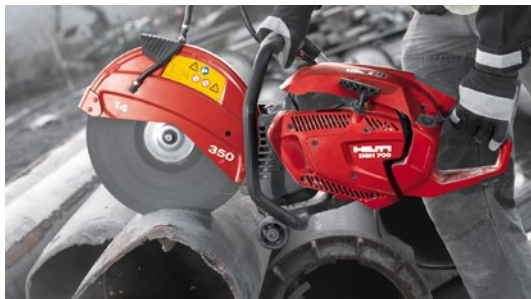
Corte de tuberías de fundición con discos abrasivos.
