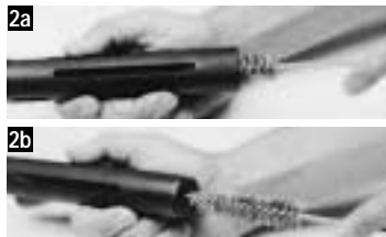
Kolbenführung und Kartuschenlager mit Rundbürste innen. Mit Hilty Spray leicht einsprühen.
