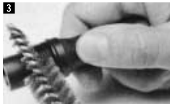
Bolzenführung aussen. Achtung: O-Ring nicht beschädigen.
