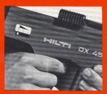
El indicador de la regulación de potencia en posición atrasada indica potencia máxima.
