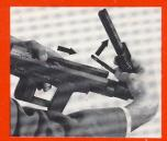
Girar y mover hacia adelant la palanca de carga. Empujar hacia adelante el rail en el
