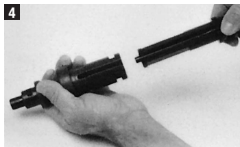
Standplatte mit Bolzenführung von der Kolbenführung abziehen.
