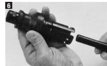
Bolzenführung aus der Standplatte gleiten lassen.
