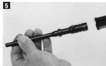
Kolben aus der Kolbenführung ziehen.
