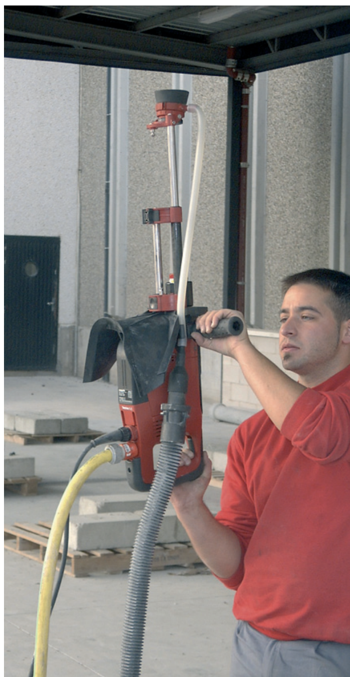
Las fotos de sistema ayudan a comprender el uso de cada artículo. En la imagen, cubierta para techos de la Hilti DD EC-1 montada.
