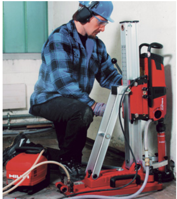
La nueva conexión rápida Hilti BL permite un montaje de las brocas cómodamente sin llaves.
