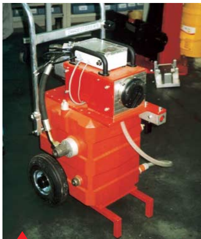
Grupo hidráulico de pruebas para garantizar reparaciones correctas.
