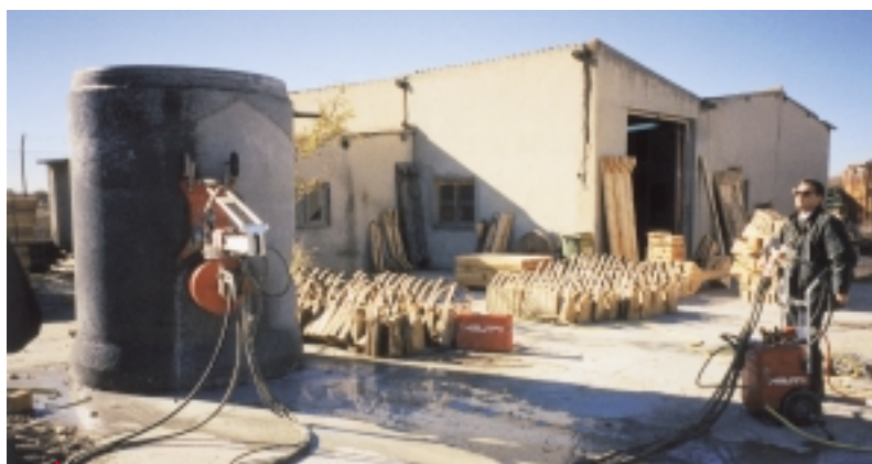
El equipo hidráulico de perforación DD 750, para taladros de hasta 1 m de diámetro.
