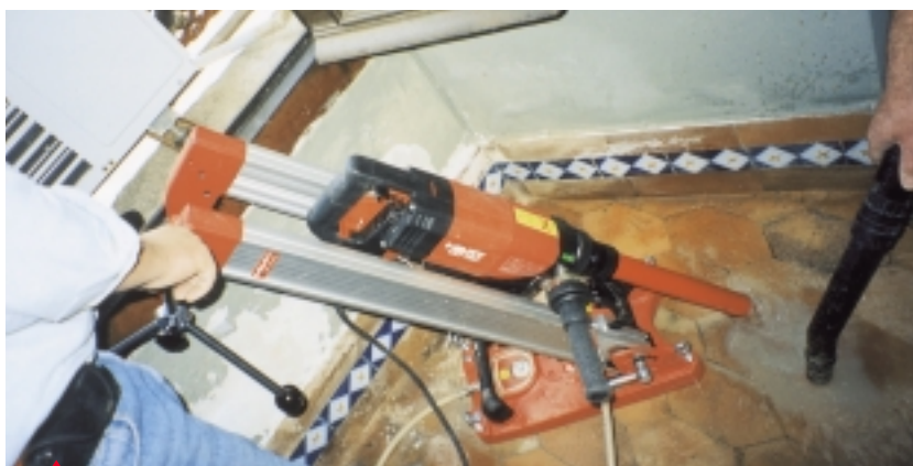
Uso con columna con cono de inclinación de serie.
