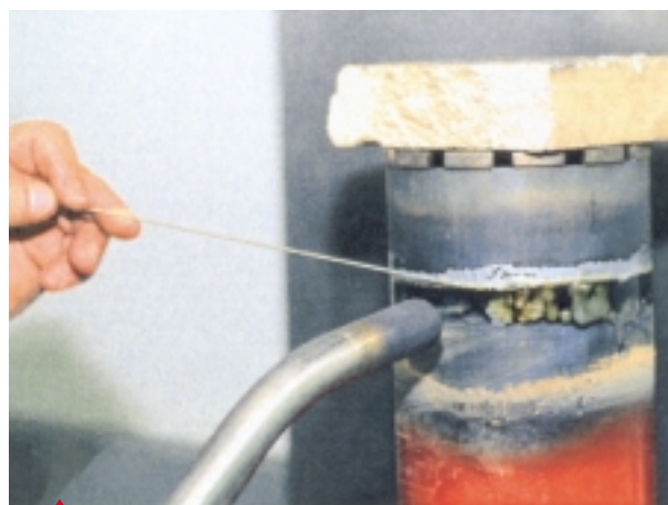
La soldadura del módulo se realiza con varilla de plata.
