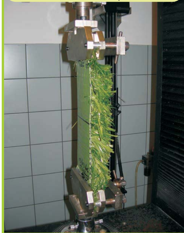
Prueba de resistencia de la unión de las lienzos de césped artificial realizada con el método de tracción directa de acuerdo con la norma europea EN 12228
