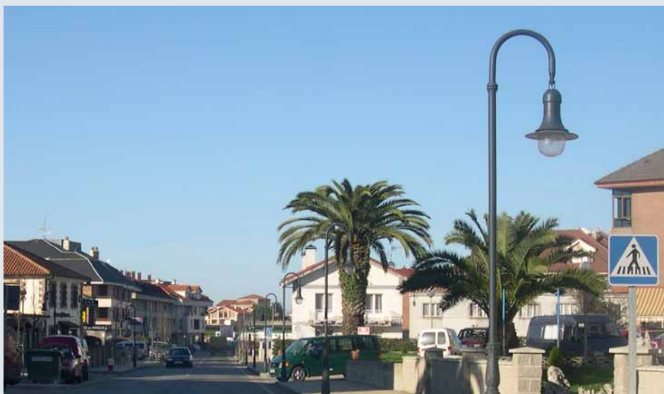
Luminaria colgante basada en el diseño de antiguos faroles de pesca. Fabricada en aluminio y difusor de policarbonato.
