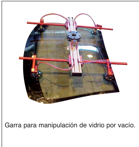
Garra de vacío (VGS) Manipulación de vidrio para el automóvil.
