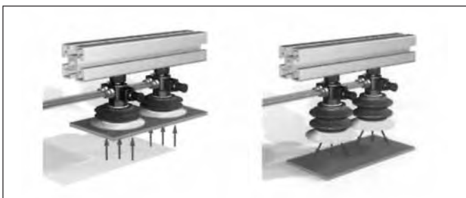
Liberación rápida - a) Vacío, b) Soplado
