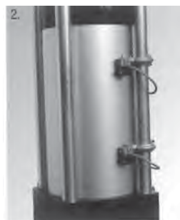
2. Sensores magnéticos con soportes de fijación.
