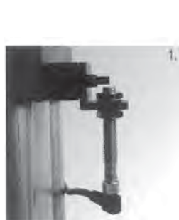
1. Grupo de sensores de proximidad con soporte.
