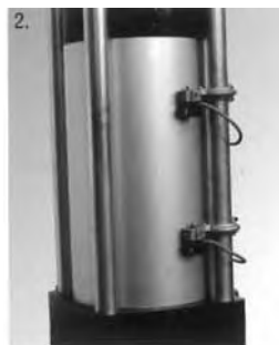
2. Sensores magnéticos con soportes de fijación.
