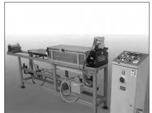
AN 200 x 600 Alimentador neumático con chasis, enderezador flotante, cizalla y cuadro eléctrico.
