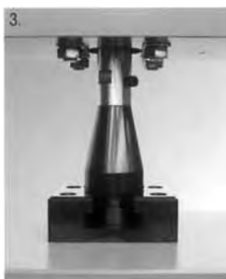
3. Conexión de bayoneta para la fijación del útil.
