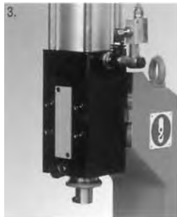
3. Bloque limitador de la carrera total con antirrotación del vástago.
