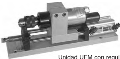
Unidad UFM con regulador hidráulico de velocidad
