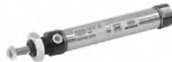
Cilindro con tapa con alimentación posterior en el eje (*) Diámetros: 8 a 25 mm Recorrido hasta: 1000 mm
