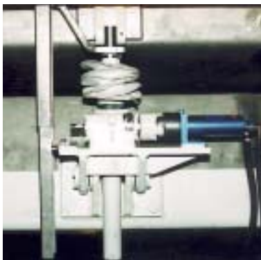
Motor tipo: NF 224 montado sobre un cilindro de husillo de bolas. Potencia máx: 0,53 Kw (0,72 Hp); Par de arranque: 1,3 daNm; Velocidad óptima: 200 a 950 r.p.m.
