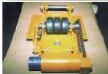
Motor tipo: NF 334 36 Potencia máx: 1,25 Kw (1,7 Hp); Par máx.: 15,6 daNm; 15,8 daNm; Velocidad óptima: 25 a 110 r.p.m.
