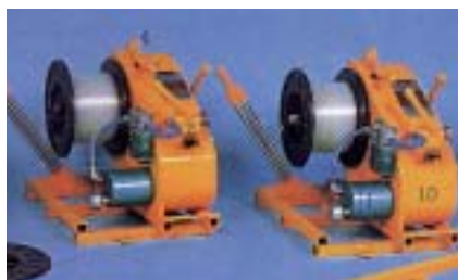
Motor tipo: NF 226 Potencia máx: 0,54 Kw (0,73 Hp); Par de arranque: 1,3 daNm; Velocidad óptima: 130 a 580 r.p.m.
