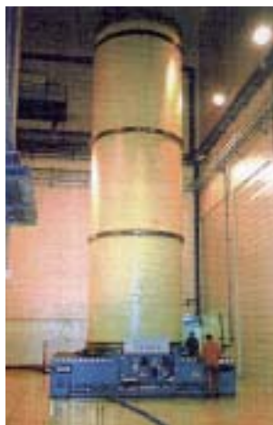
APLICACION: manutención sobre cojines de aire de un segmento del motor principal de cohete Ariane V (Peso total 150 Tm) Motor tipo: NF 334 36 (20 unidades) Potencia máx: 1,27 Kw (1,7 Hp); Par de arranque: 15,8 daNm; Velocidad óptima: 25 a 110 r.p.m.
