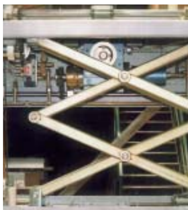
Motor tipo: LF 5 Potencia máx: 2,7 Kw (3,75 Hp); Par de arranque: 3,7 daNm; Velocidad óptima: 250 a 1100 r.p.m.
