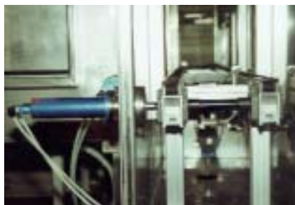
Motor tipo: NF 224 24 Potencia máx: 0,53 Kw (0,72 Hp); Par máx.: 3,4 daNm; Par de arranque: 3,5 daNm; Velocidad óptima: 50 a 210 r.p.m.
