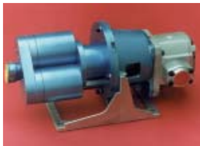
Motor tipo: 2XE7X con reductor Potencia máx: 8,2 Kw (11 Hp); Par de arranque: 9,2 daNm; Velocidad óptima: 320 a 1600 r.p.m.
