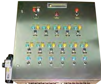
Cuadro de control de válvulas de dosificación de silos para industria alimentaria.
