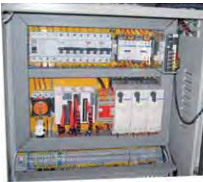
Cuadro de control para unidades de taladro eléctricas en máquina para el taladrado de depósitos de motocicletas.
