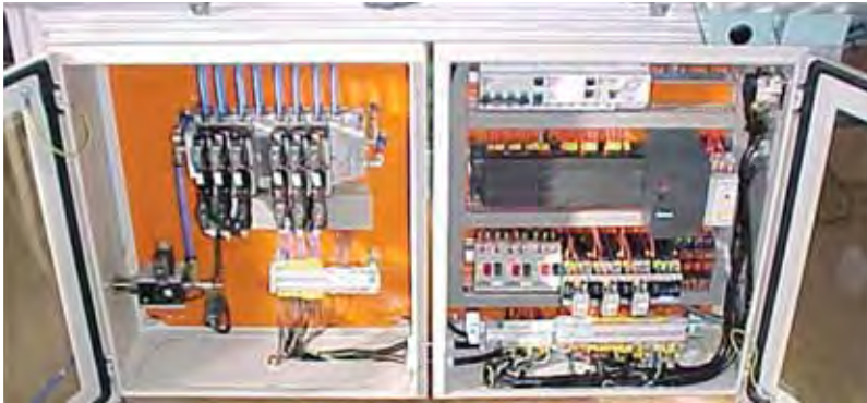
Cuadros de control de máquina de taladrado para depósitos de automoción.
