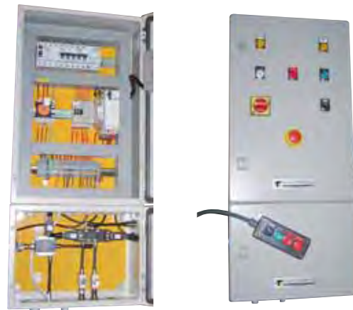
Cuadro para mando de control de unidad de taladrado.
