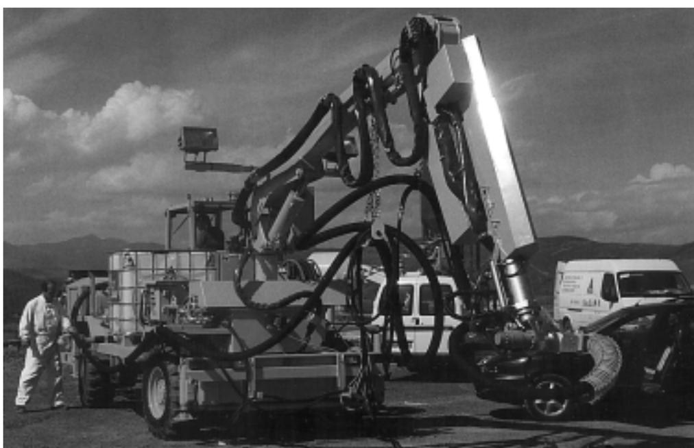
*Fig. 7. Robot de proyección por vía seca-semihúmeda.*
