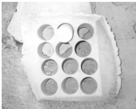
*Fig. 19. Extracción de testigos de hormigón proyectado.*
