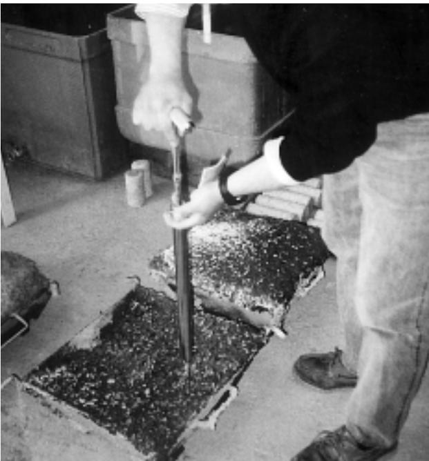
*Fig. 17. Medición de resistencias iniciales mediante ensayo Proctor.*
