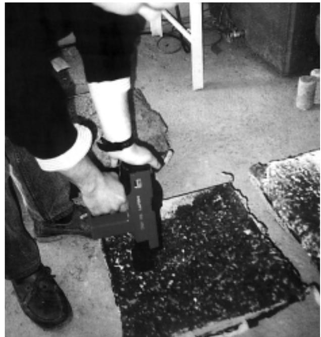
*Fig. 18. Medición de resistencias iniciales mediante ensayo Hilti de penetración-extracción de pernos.*
