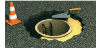
Amasar Sika® FastFix 138-TP con consistencia seca y preparar la capa base de la pieza a fijar.
