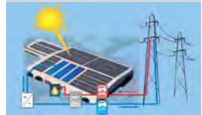
Esquema de suministro de energía captada vertida a la red
