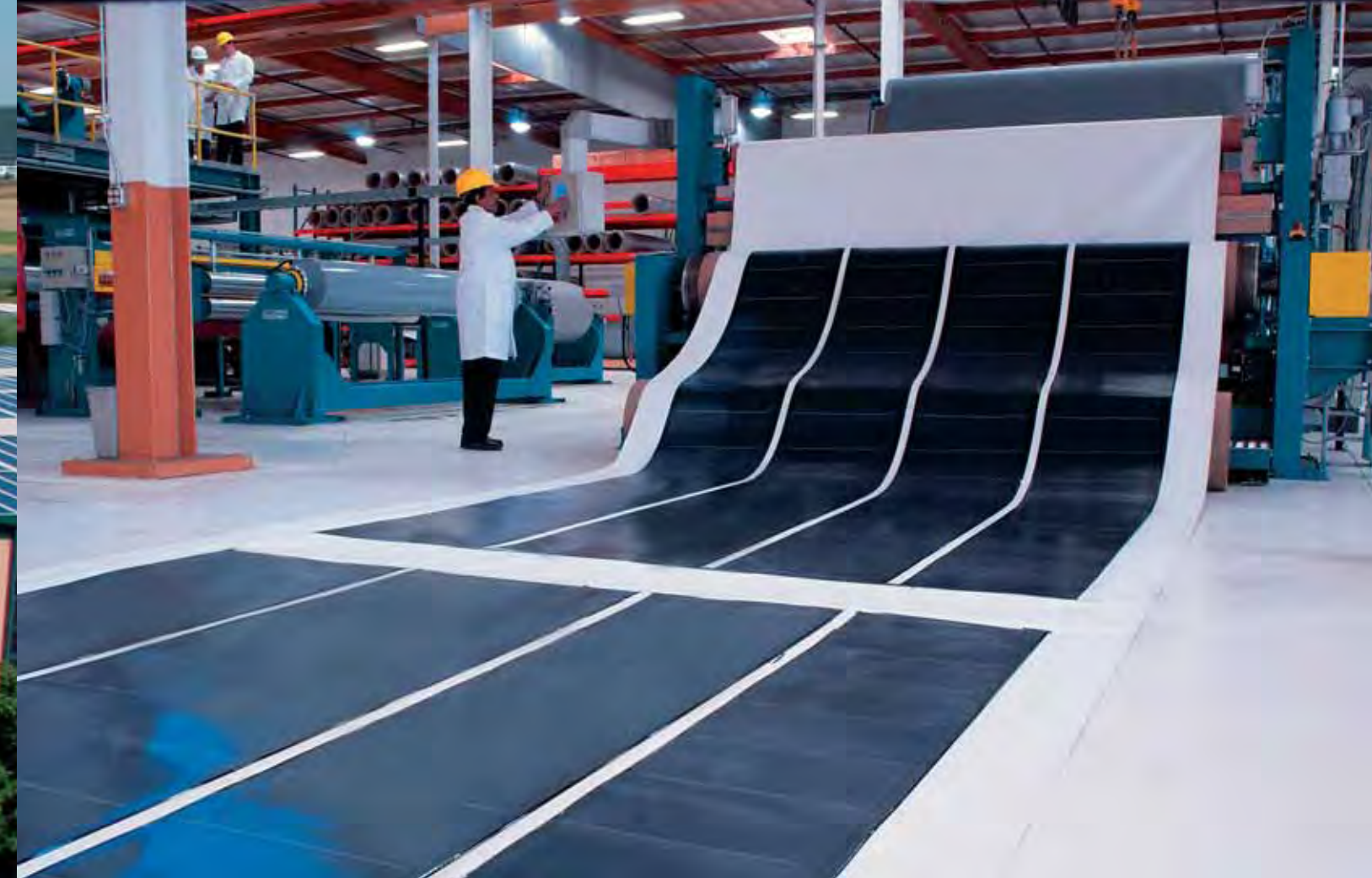
Proceso de fabricación de Módulos-PV
