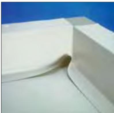
Aplique tiras de **Sikaplan®** y fijelas de manera provisional sobre el peto. También los puede hacer soldando directamente la tira **Sikaplan®** sobre el perfil colaminado **Sika®**. Si la altura del peto es mayor de 50 cm, tendrá que fijar las tiras mecánicamente o con adhesivo sobre la superficie vertical. (ver capítulo 4.14)
