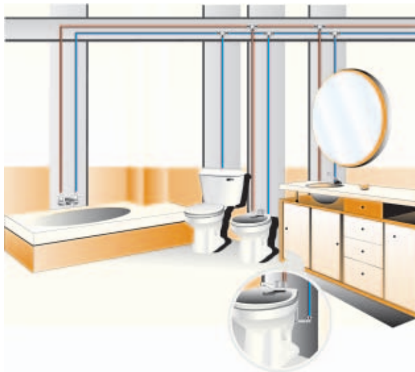
Distribución interior mediante derivaciones Número de piezas: 5 Número de uniones: 15
