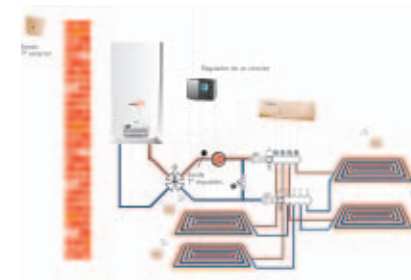
Solución 7. Caldera SD + conjunto de regulación + válvula de zona de 2 vías + actuador por circuito + 2 termostatos ambiente
