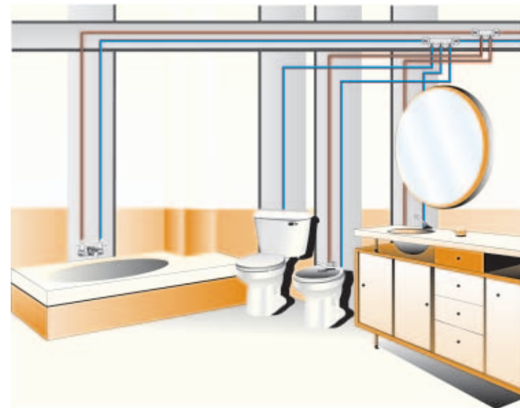
Distribución interior mediante colectores Número de piezas: 2 Número de uniones: 9
