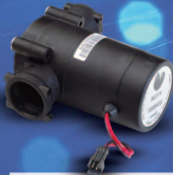
El Nuevo sistema **Aquaflam** se caracteriza porque el aislamiento entre la zona húmeda (turbina) y la zona seca (generador eléctrico) es total. El acoplamiento entre la turbina situada en la parte de agua y el generador es magnético. **No hay partes eléctricas en contacto con el agua** y, por tanto, el riesgo de que una fuga de agua dañe el sistema es inexistente.
