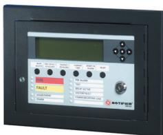
El controlador sinóptico consta de una unidad de control principal más un máximo de 8 controladores sinópticos adicionales de 64 salidas de colector abierto cada uno, lo que proporciona un total de 512 salidas de colector abierto. La placa del sinóptico principal dispone de 8 entradas/salidas digitales programables para realizar funciones de rearme, reconocimiento o control de relés.
