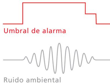
El Sensor Optiplex aumenta su umbral de alarma cuando detecta presencia de ruido ambiental (por ejemplo, humo procedente de cigarrillos). Cuando las condiciones ambientales se estabilizan, el Optiplex reacciona al cambio y se vuelve más sensible.
