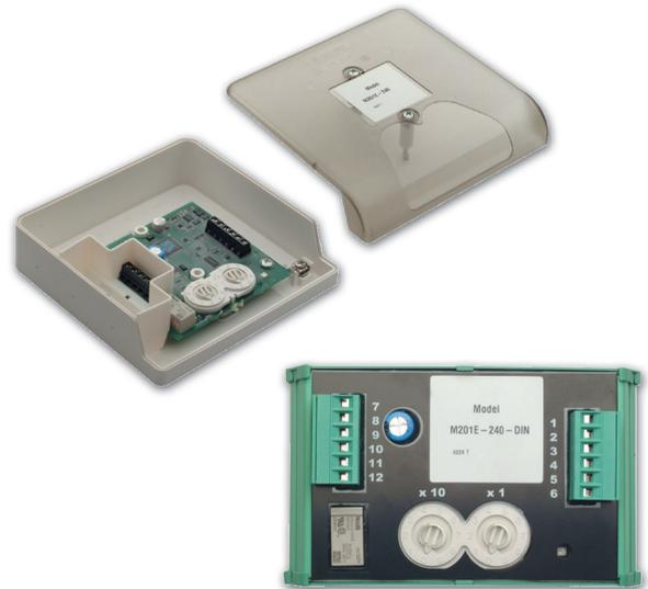
**M701-240.** Módulo diseñado para realizar las maniobras de activación/desactivación a través del lazo de comunicaciones, en los sistemas que trabajan con tensiones nominales de 240 Vac, mediante un contacto libre de tensión NA/NC independiente. Dispone de dos bloques de terminales de 6 vías independientes para conectar el circuito de comunicación del lazo y el circuito de relé NA/NC de conmutación de 240 Vac, con compartimentos separados. Cumple la directiva de seguridad eléctrica.
