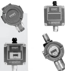
Los detectores de la serie **SMART 3 CD** ofrecen la posibilidad de verificar y realizar la calibración del detector sin la necesidad de desclasificar el área protegida, abrir el detector o desplazarlo de la zona de riesgo. Para ello es necesario utilizar el teclado de calibración de acción magnética incluido por defecto en el detector.
