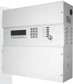
La central del sistema de detección de gas Galileo MULTISCAN es un sistema ampliable, diseñado para controlar y gestionar los sensores de gas analógicos con salida proporcional de 4-20 mA: inflamables, tóxicos, carencia de oxígeno, etc.
