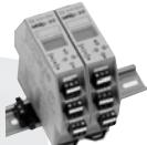
El controlador Unipoint de Zareba es un equipo económico y versátil que actúa como interfaz para la conexión y control de un detector de gas (tóxico, inflamable o de carencia de oxígeno). Se puede conectar al sistema analógico de detección de incendios a través de módulos de la serie M700. **Requiere una fuente de alimentación auxiliar de 24 Vcc** y montaje en guía DIN.
