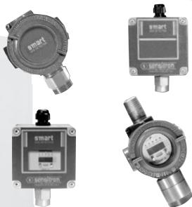
Los detectores de la serie SMART 3 IrDA ofrecen la posibilidad de verificar y realizar la calibración del detector sin la necesidad de desclasificar el área protegida, abrir el detector o desplazarlo de la zona de riesgo. Para ello es necesario utilizar el teclado de calibración ST.S/CKD IrDA con enlace de transmisión bidireccional por infrarrojos.
