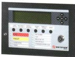
El controlador sinóptico consta de una unidad de control principal más un máximo de 8 controladores sinópticos adicionales de 64 salidas de colector abierto cada uno, lo que proporciona un total de 512 salidas de colector abierto. La placa del sinóptico principal dispone de 8 entradas/salidas digitales programables para realizar funciones de rearme, reconocimiento o control de relés.
