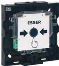
Módulo electrónico de pulsador de alarma de incendios analógico Diseño Grande. Incorpora botón de accionamiento, grupo de contactos, led rojo de indicación de alarma y segundo contacto de relé. Serigrafía impresa según EN54-11 con indicación de operación en caso de alarma.
