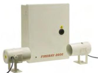
Barrera de detección de humos por haz de Infrarrojos. La barrera incorpora emisor, receptor y unidad de control. Alcance hasta 100m. Control automático de ganancia, sensibilidad ajustable entre 25%, 35% y 50% de oscurecimiento por metro.
