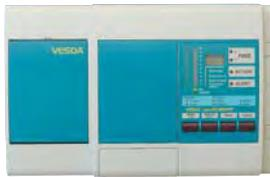
Detector precoz de humos por aspiración con tecnología láser VESDA Láser Scanner para 4 tuberías con módulo de control incorporado y programador. Desde el programador incorporado se puede tener acceso a todos los demás detectores instalados en la red VesdaNet. Requiere alimentación exterior 24Vdc.
