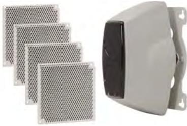
Barrera óptica de humos con emisor y receptor ubicados en el mismo equipo. Alcance de 35 a 100m. Incorpora relé de alarma y avería. Protección IP50. Control automático de ganancia y sensibilidad ajustable entre 25%, 35% y 50% de oscurecimiento por metro. La barrera se debe montar a una distancia de entre 0,3 a 0,8 m del techo, no debiendo haber obstáculos reflectivos en la zona de transmisión (aproximadamente de 2 grados).
