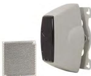
Barrera óptica de humos con emisor y receptor ubicados en el mismo equipo. Alcance de 10 a 50m. Incorpora relé de alarma y avería. Control automático de ganancia y sensibilidad ajustable entre 25%, 35% y 50% de oscurecimiento por metro. La barrera se debe montar a una distancia de entre 0,3 a 0,8 m del techo, no debiendo haber obstáculos reflectivos en la zona de transmisión (aproximadamente de 2 grados).
