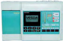
Detector precoz de humos por aspiración con tecnología láser VESDA Láser Plus para 4 tuberías con módulo de control y programador incorporados. Desde el programador incorporado se puede tener acceso a todos los demás detectores instalados en la red VesdaNet. Requiere alimentación exterior 24Vdc.
