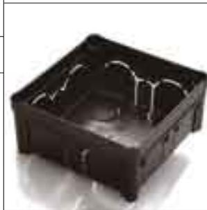
Entradas pretroqueladas tanto en el fondo como en los laterales, que permiten la entrada de conductos de 25 y 32 mm. de diámetro.
