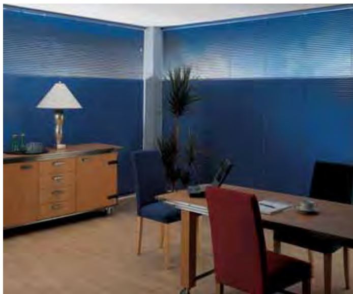
La persiana veneciana con aprovechamiento óptimo de la luz diurna lleva una discreta pieza de sujeción que divide en un sector de bloqueo y otro de desviación de la luz solar.
