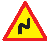
REF. TP-14-A Curvas peligrosas, la primera hacia la derecha
