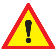
REF. TP-50 Otros peligros
