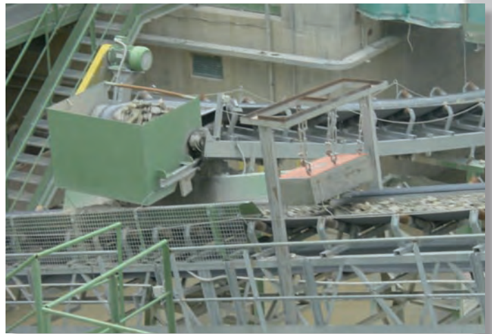
Sistema di pulizia rapida a libro · Sistema de limpieza rápida a libro Système de nettoyage rapide à livre · Quick cleaning linged or slip systems Plattensystem für schnelle Sauberkeit
