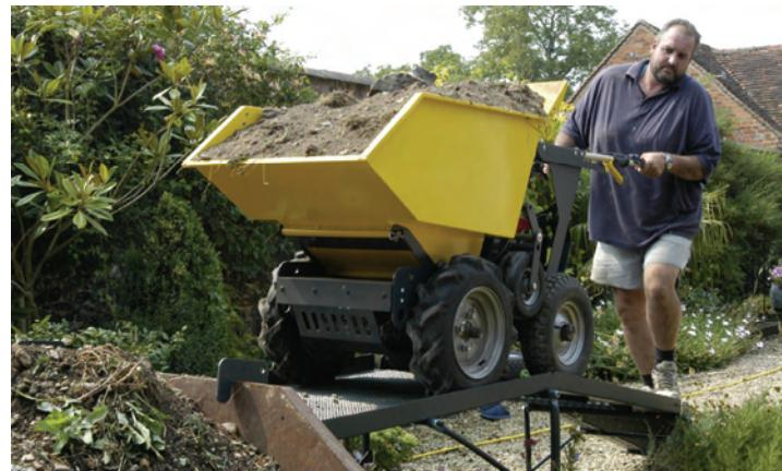
La descarga total del volquete perpendicular al suelo asegura un vaciado total del material transportado.
