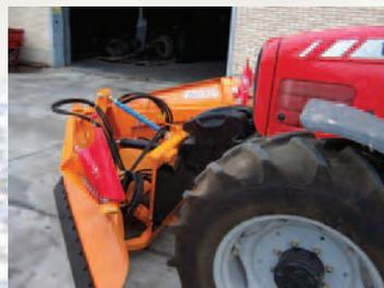
La punta y las alas son fuertes con nervios y reforzadas (8/15 mm). Por su particular diseño la cuña puede trabajar con la punta, barriendo
