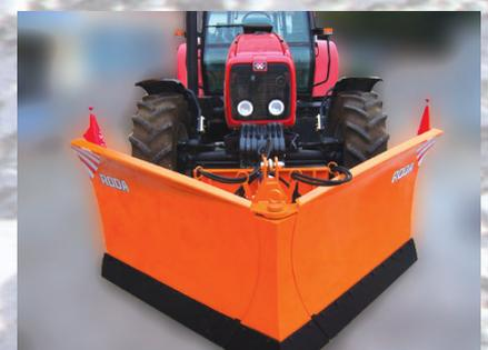
El centro de rotación de las 2 láminas está muy cerca de la placa de enganche del vehículo ya que la construcción está reducida al máximo consiguiendo una longitud de 107 cm entre la placa de enganche y el centro de rotación.
