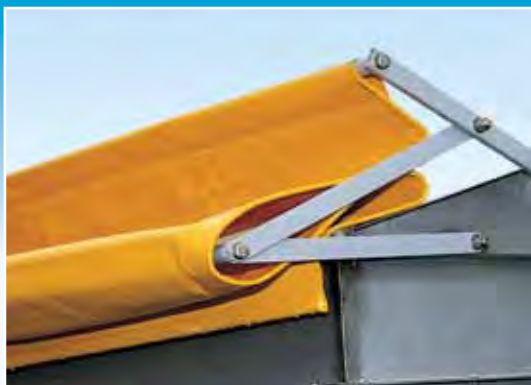
Tela de cobertura en PVC con apertura rápida
